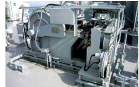
環境センサー付多段開閉ネットウインチ MOCNESS NET WINCH
