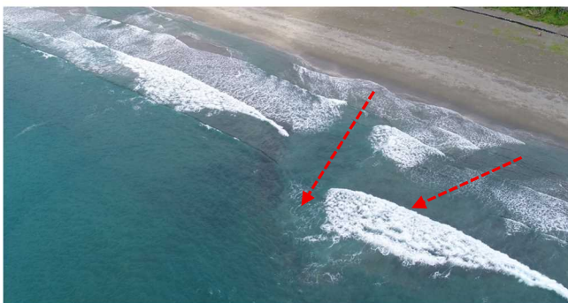
写真-4 リップチャンネル地形（写真中央部やや右下側付近で沿岸砂州が切れた箇所）
