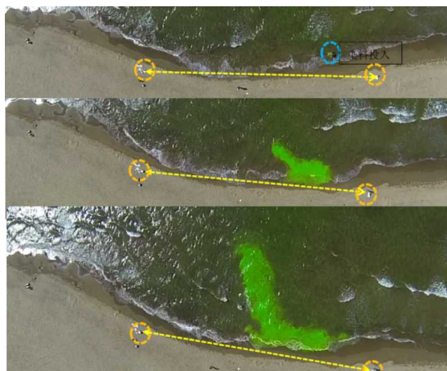
写真-23 海水浴場で発生している離岸流(左は構造物に起因、右は海底地形に起因)
