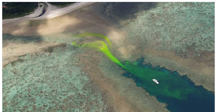
写真-18 リーフギャップに流出するリーフカレントの様子（注意；流れの幅が狭いほど流れが速い）
