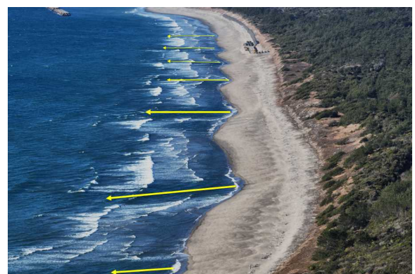
写真-5 汀線のラージカスプ地形とリップチャンネル地形（写真中央部付近）
