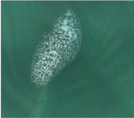
写真-14 小型船舶等の事故原因になり 易い球面浅瀬での波の変形の様子
