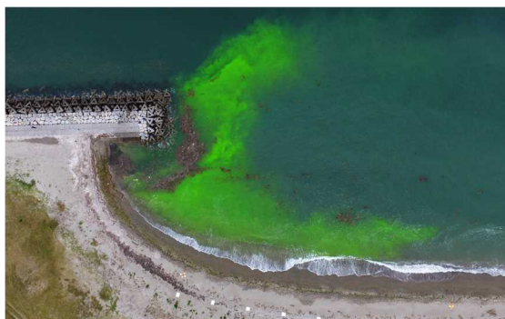
写真-23 海水浴場で発生している離岸流(左は構造物に起因、右は海底地形に起因)
