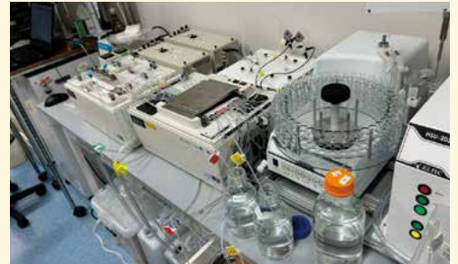
オートアナライザーを用いて栄養塩濃度を測定しています(水質モニタリング)。
