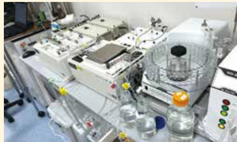
オートアナライザーを用いて栄養塩濃度を測定しています(水質モニタリング)。
