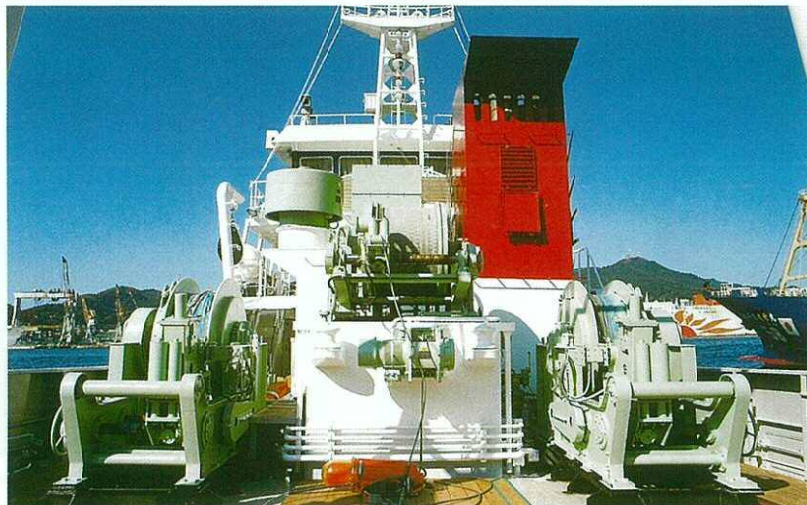
トロールウインチ(左右)、ネットソナーウインチ(中央) Trawl winch (P.S) Cable trawl sonar winch (Center)
