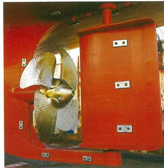
推進器・シリング舵 Propeller・Schilling rudder
