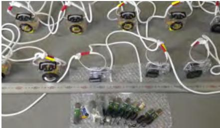
写真1 水温の鉛直分布を計測するための観測ユニット
