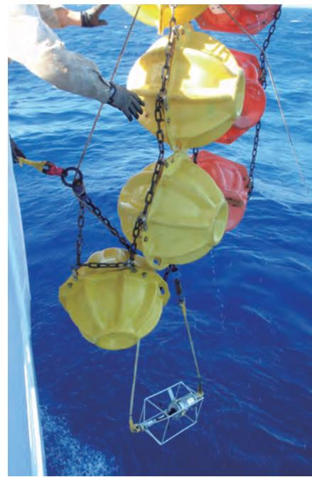
写真2. 三次元超音波流速計（三次元超音波流向流速計に錘とブイをつけて係留し、海中の流れを1年間にわたって連続観測する。こういう気長な観測も行っている。）
